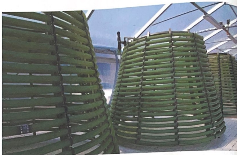
Les photobioréacteurs pour la production d'algues sont utilisés en vue de produire des métabolites ciblés pour les défenses naturelles de la vigne.
