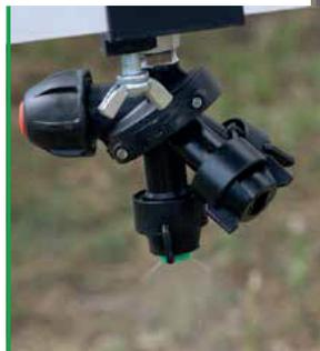
L'effet tensioactif des adjuvants élargit le pinceau de traitement en sortie de buse.
